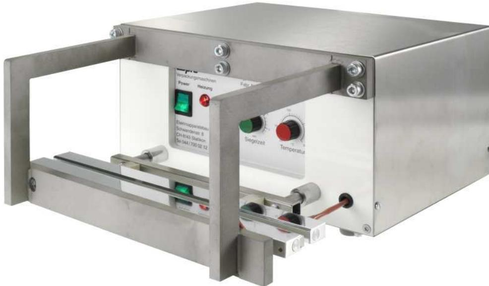
Der Siegelvorgang wird mit einem Fusschalter ausgelöst.
